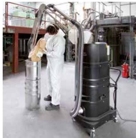
R01 R075 Praf explozibil, cu braț de aspirație în producția de mase plastice
