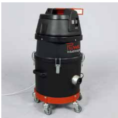
WS 200 Zone 22 cu recipient din material plastic conductiv și priză automată (ascunsă)
